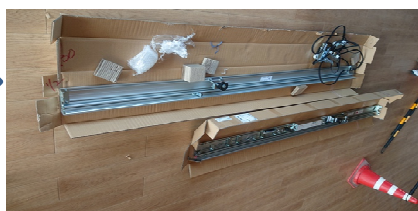
⑤ 自動ドア開閉装置
