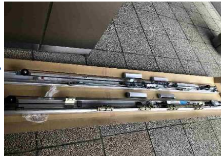
④ 新・自動ドア開閉装置
